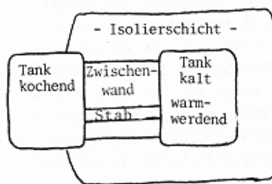
Abb. 37: Wärmeausgleich bei Berühren von Stabenden
