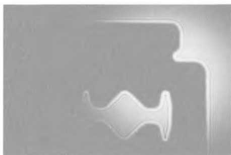
Difrakce světla se projevuje jako roztřepeně okraje, které obklopují žiletku. Zde bylo použito laserové osvětlení.
